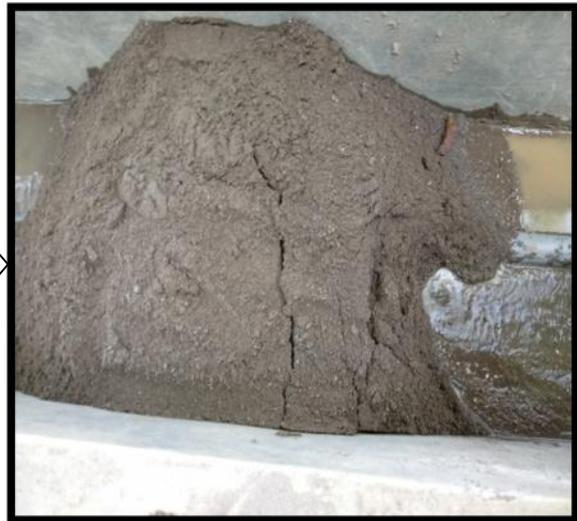
Gambar 9. Pemindahan sedimen dari saringan ke dalam wadah.
