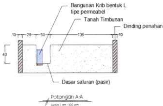
Gambar 15. Potongan Melintang Saluran.
