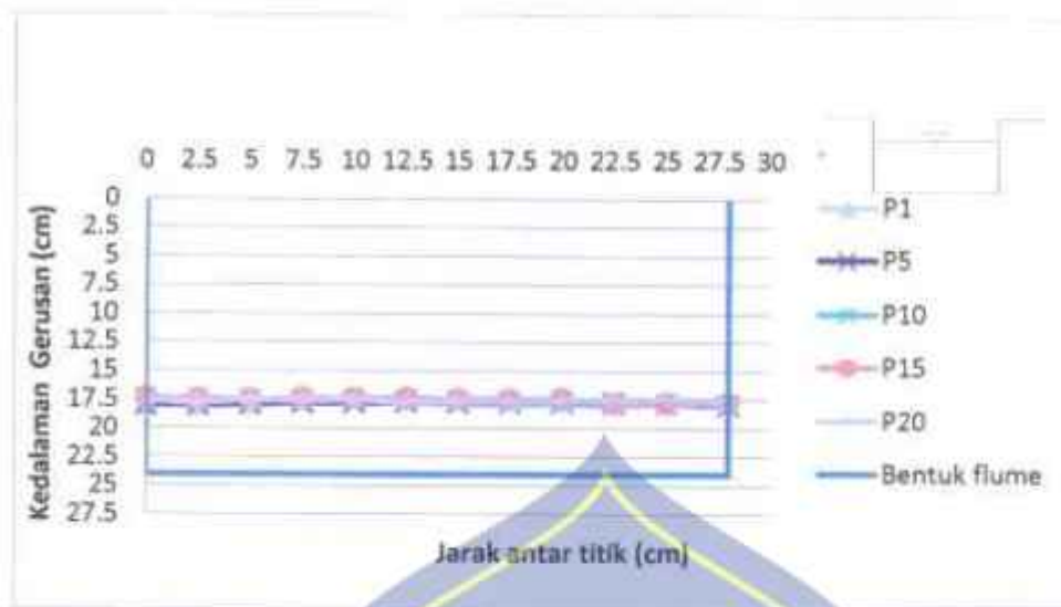
Gambar 26 Hubungan Elevasi Dasar Saluran dengan Jarak antar Titik Pias Menggunakan Baffle Block 1 : 1
