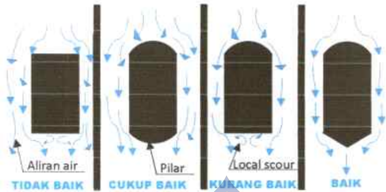
Gambar 3 Aliran air pada penampang Pilar
