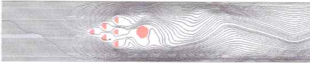
Gambar 10 Hasil pola aliran di sekitar pilar dan tirai menggunakan software iRIC: Nays2DH 3.0
