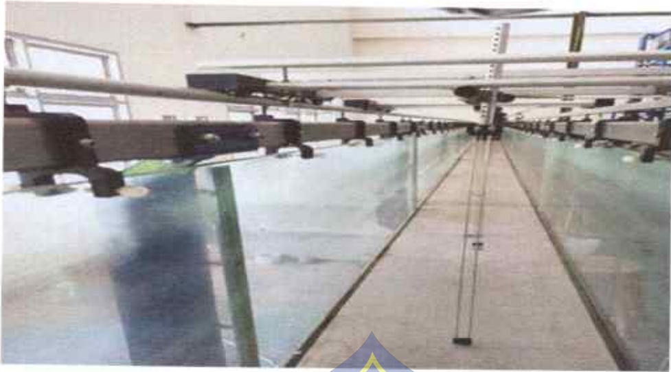
Gambar 6. Posisi Probe pada Flume
