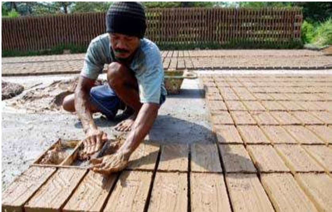
Gambar 5. Proses pencetakan batu merah
