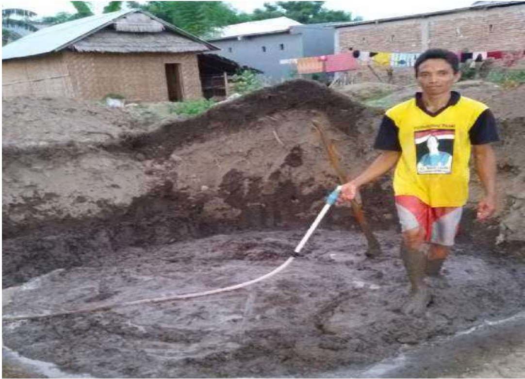
Gambar 4. Proses pencampuran bahan batu merah
