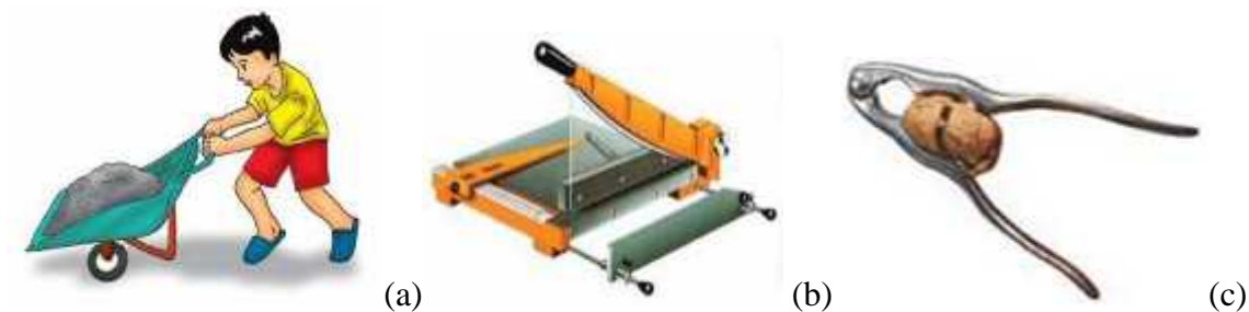
Gambar 5 Tuas golongan kedua, misalnya (a) gerobak roda satu, (b) alat pemotong kertas, (c) alat pemecah kemiri
