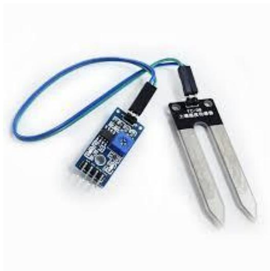
**Gambar 2.1. Sensor kelembaban tanah**
