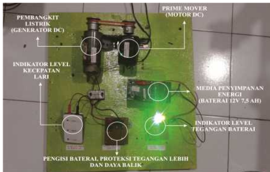
Gambar 4.1 Realisasi desain sistem penyimpanan energi
