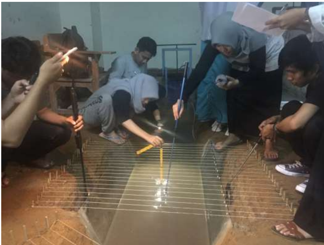
Pengambilan data kecepatan aliran ( h ) dan ketinggian aliran ( v )
