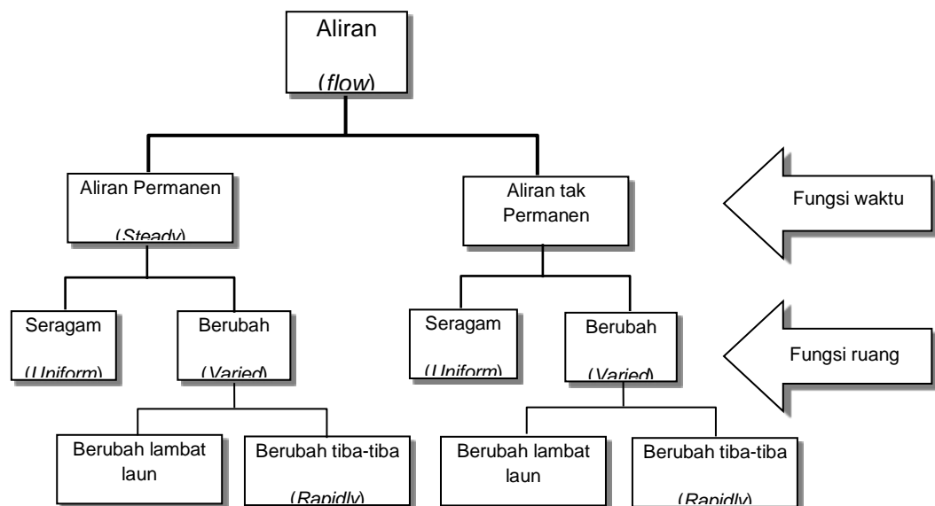
Gambar 9. Klasifikasi aliran pada saluran terbuka
