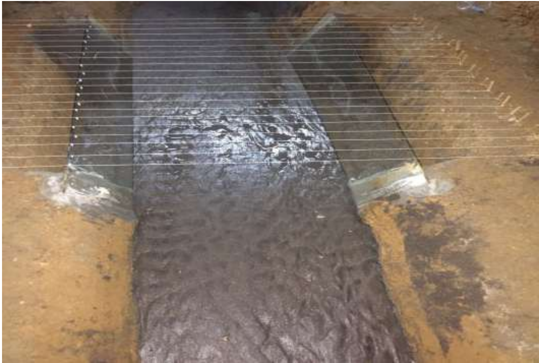
Perubahan Bentuk dasar saluran setelah pengaliran
