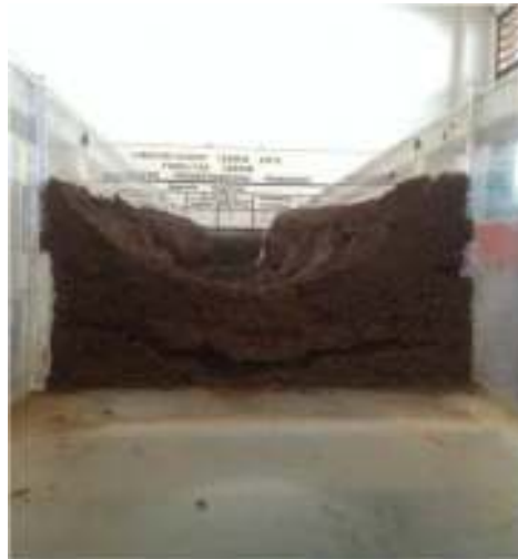
Keadaan model sungai saat dibukannya profil penampang sungai
