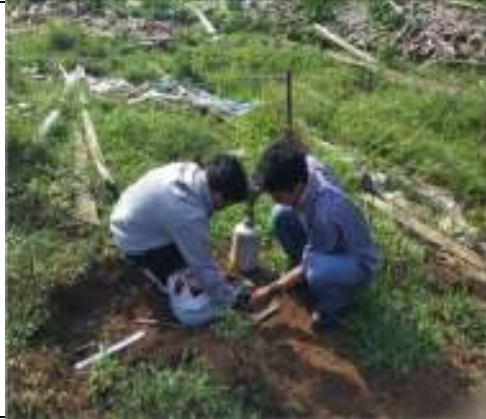
Menggali titik tanah yang akan di Sandcone
