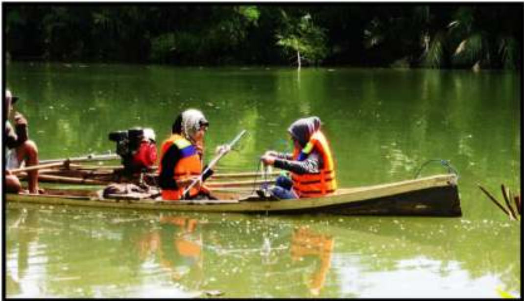
Pengukuran kedalaman sungai di Penampang A, pada bagian belokan sungai
