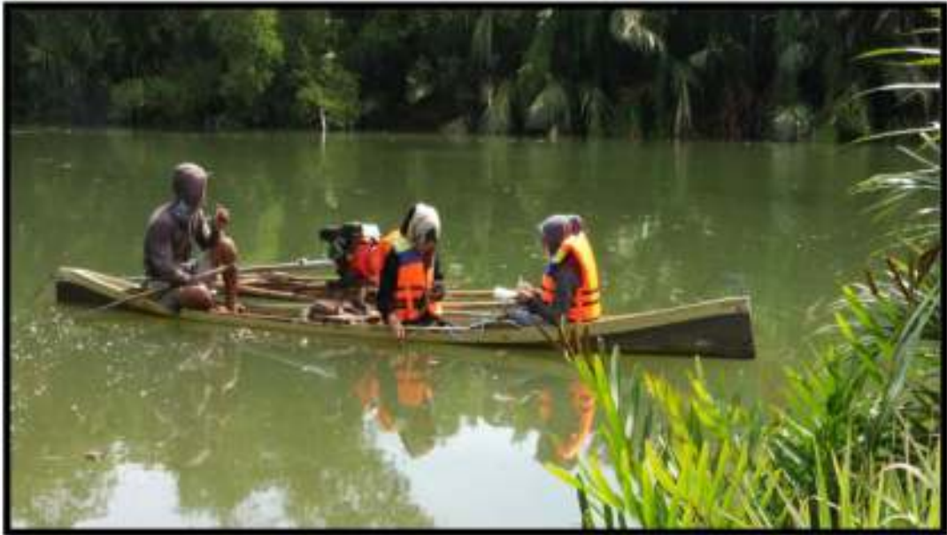
Pengukuran Kecepatan Aliran di Penampang B, pada bagian belokan sungai.
