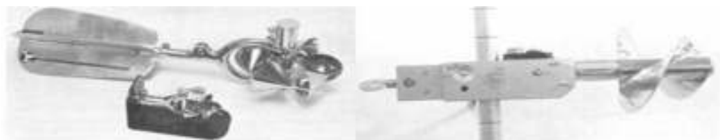
Gambar 4. (a) Cup current meter dan (b) Propoler current meter ( http://perhubungan2.wordpress.com/2012/01/2016/pengukuran-kecepatan-aliran-sungai/ )
