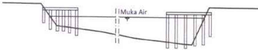
Gambar 6. Tampak Samping Krib Permeabel
