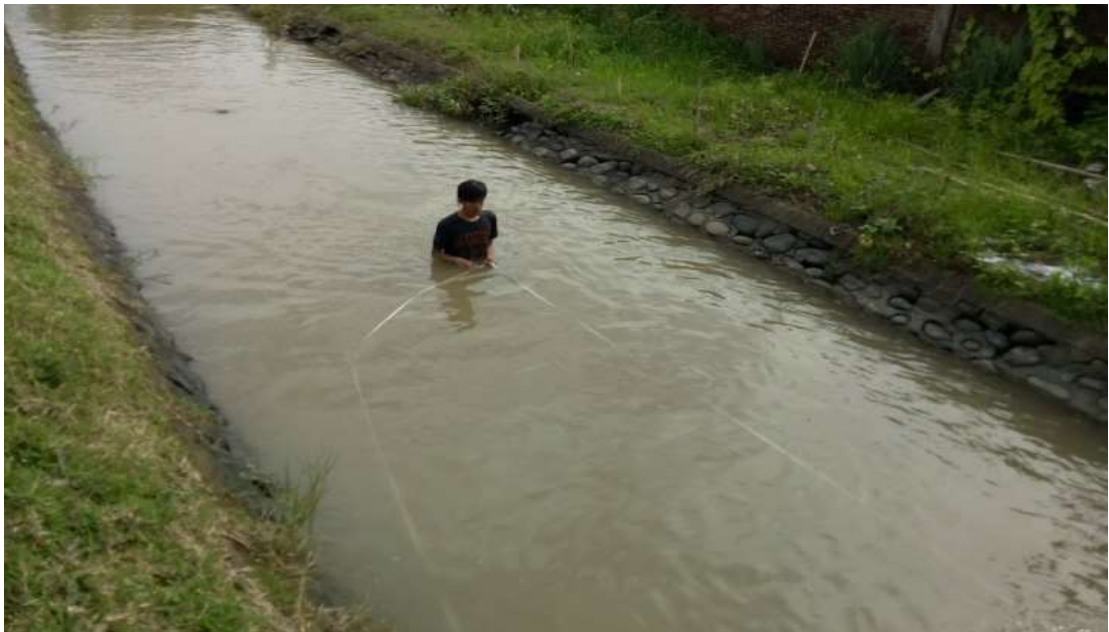
Pengambilan data kecepatan aliran menggunakan metode apung.
