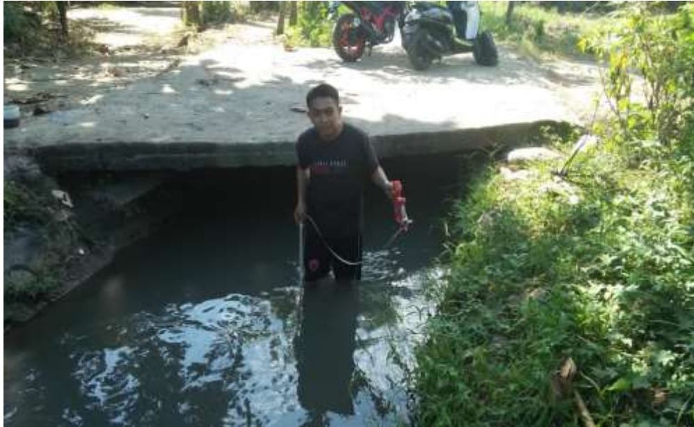
Gambar 1. Pengambilan data pengukuran tinggi muka air di saluran sekunder Bontoala
