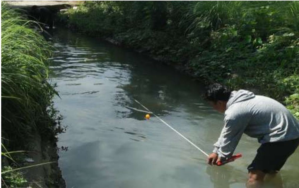
Gambar 3. Pengambilan data kecepatan aliran dengan metode apung.
