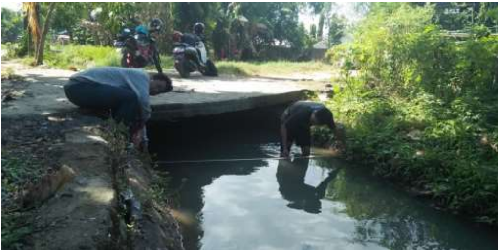
Gambar 2. pengambilan data pengukuran lebar air disaluran disaluran Bontoala.
