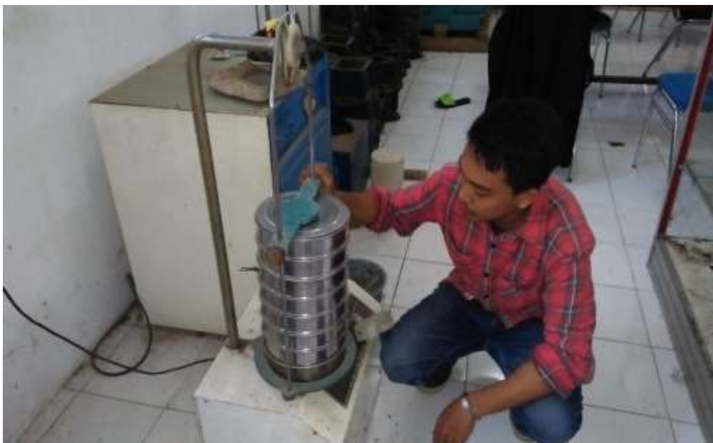
Gambar 6. Pengujian laboraterium analisa saringan sedimen dasar.
