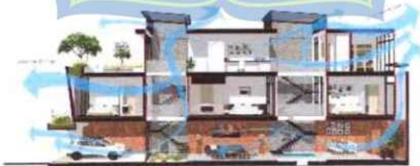
Gambar 2.4 Sistem ventilasi silang
