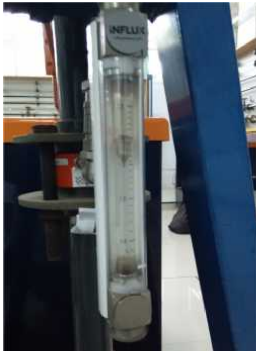
Gambar 2. Alat Ukur Debit Pada Flum.
