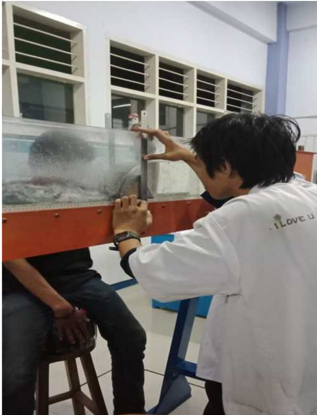
Gambar 5. Pengukuran Tinggi Muka Air di Atas Mercu.
