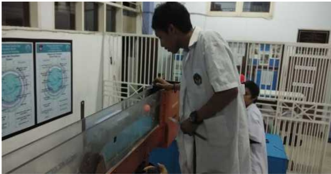
Gambar 6. Pengukuran Kecepatan Aliran Sebelum Mercu
