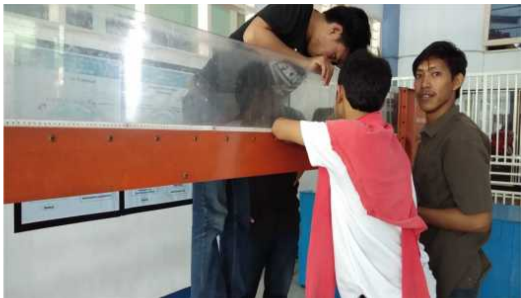
Gambar 4. Pemasangan Mercu Pada Flum.
