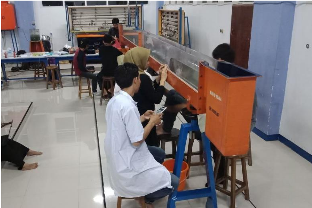
Gambar 7. Pengukuran Tinggi Muka Air Setelah Bangunan.
