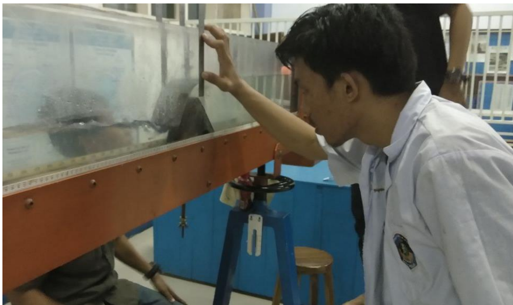
Gambar 6. Pengukuran Tinggi Muka Air di Atas Bangunan.
