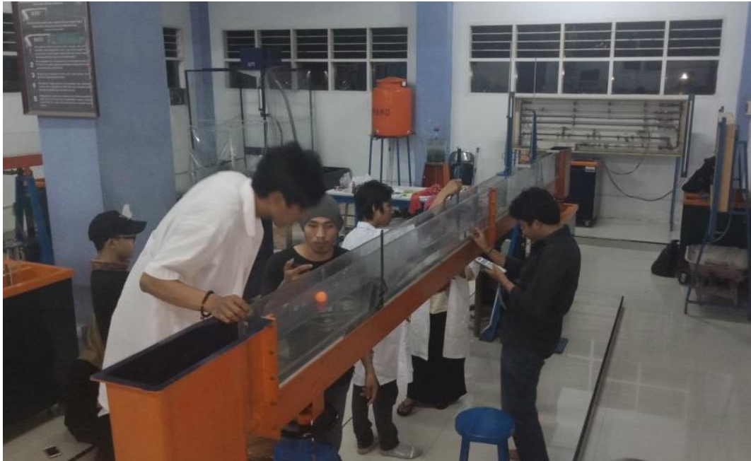
Gambar 9. Pengukuran Kecepatan Aliran Setelah Bangunan.
