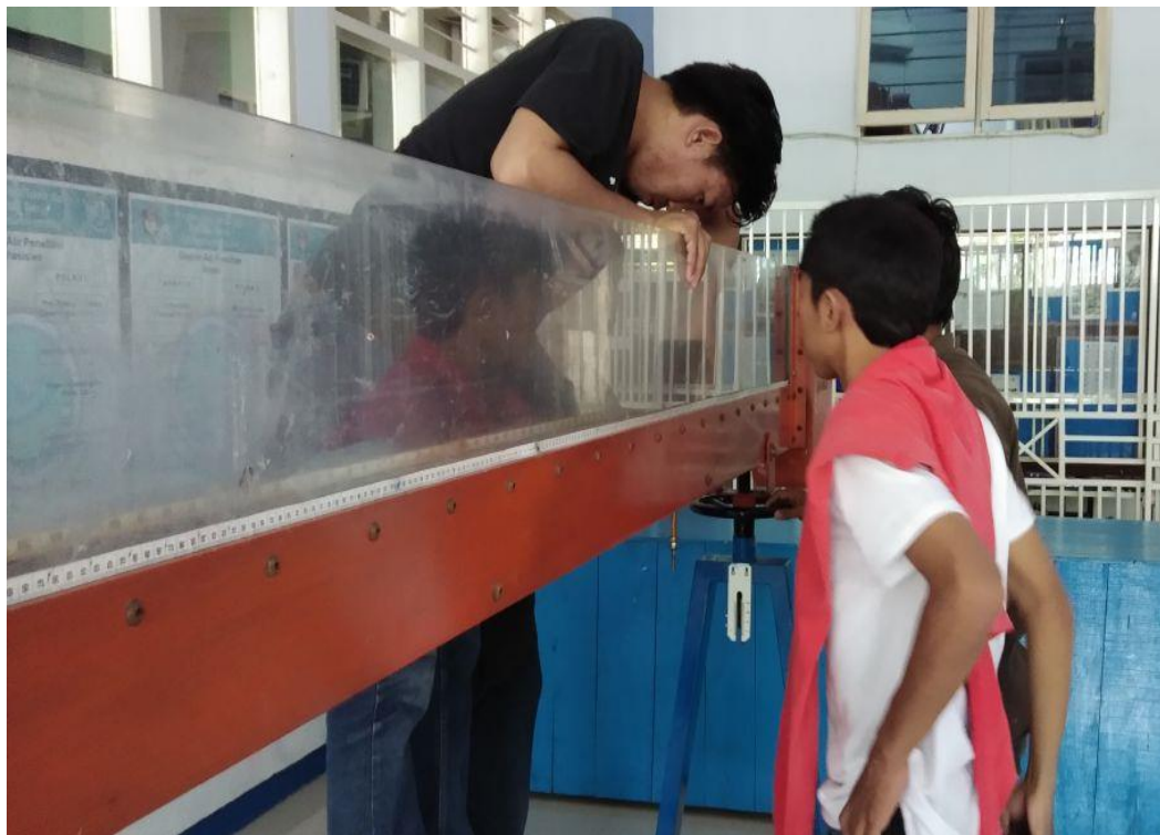
Gambar 4. Pemasangan Mercu Pada Flume.
