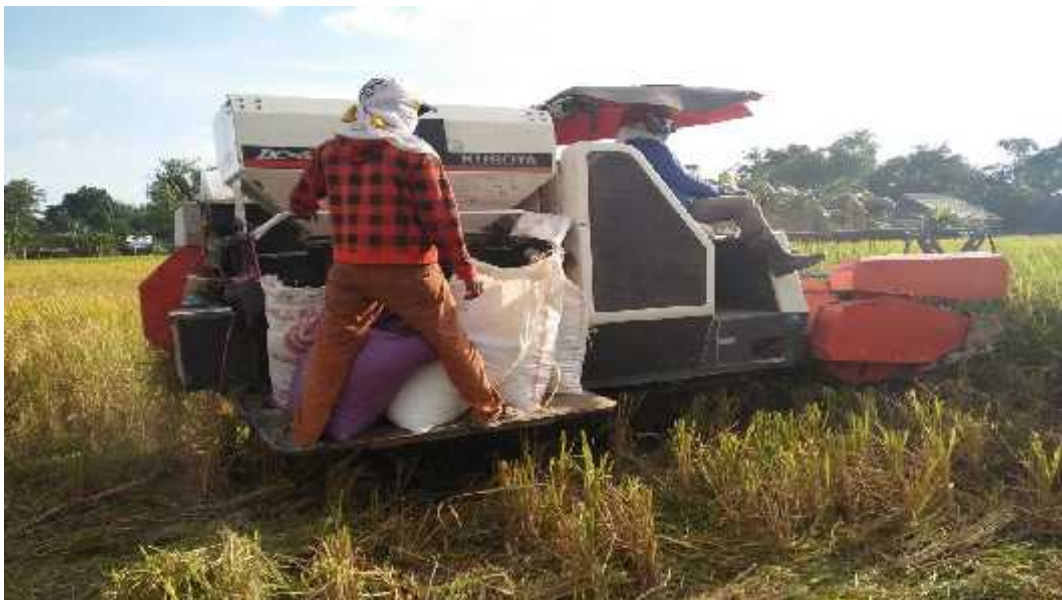
Gambar 6. Tahap pengangkutan pada mesin panen Combine Harvester
