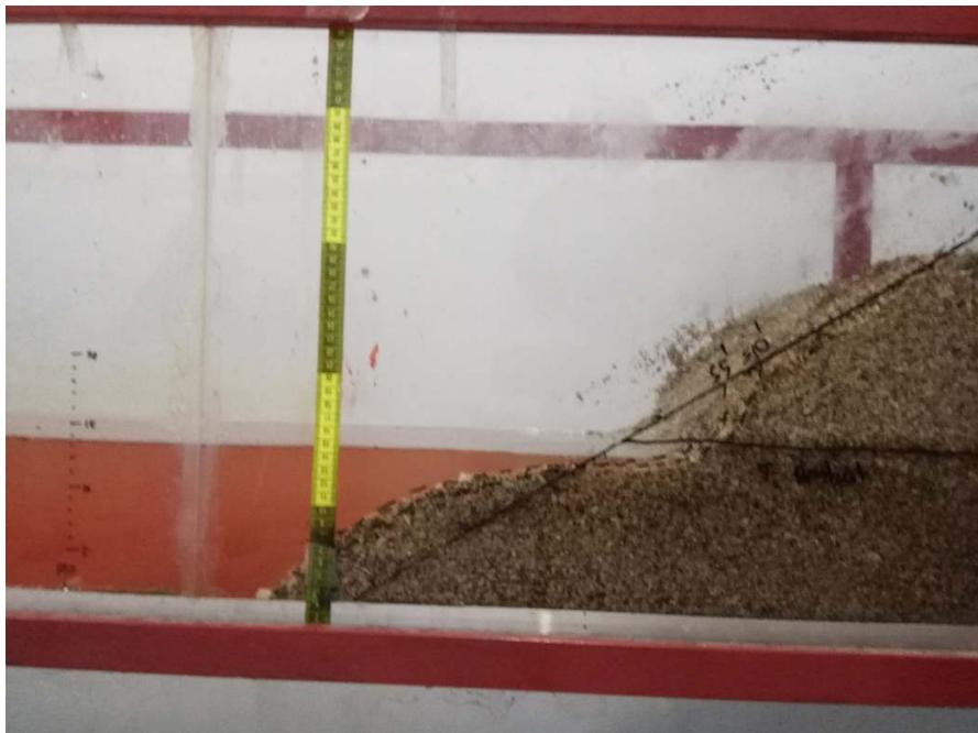
Pencatatan Tinggi Gelombang Stroke 6
