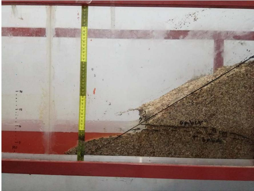
Pencatatan Tinggi Gelombang Stroke 5
