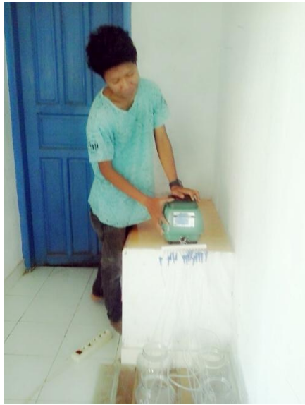
Memasang perlengkapan aerasi
