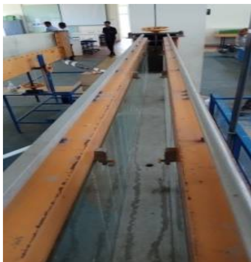
Gambar 7. Model saluran terbuka dengan penampang segi empat.
