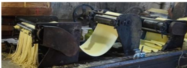
Gambar 4.7 mesin Press 1,2,3 dan mesin sisir
