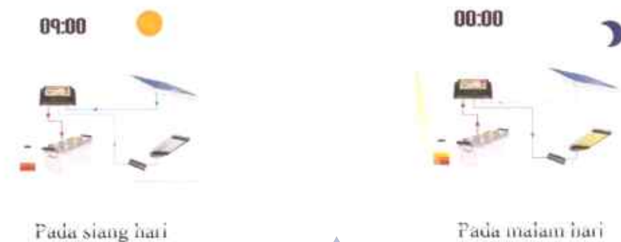
Gambar 2.6. Prinsip kerja fotovoltaiik terpadu-bangunan untuk penerangan trotoar dan jalan raya.
