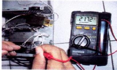
Gambar 4.1 Pengukuran masukan pin atau primary transformator
