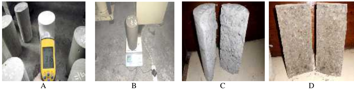
Gambar 2. Pengukuran suhu beton silinder dengan semen organik (A) Pengukuran berat beton silinder dengan semen organik (B) Silinder beton semen organik hasil uji tarik belah (C) Silinder beton semen portland hasil uji tarik belah (D)
