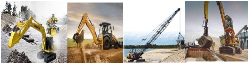
Gambar 12.3. Peralatan Menggali Excavator dan clamshell. (United Tractor 2020)
