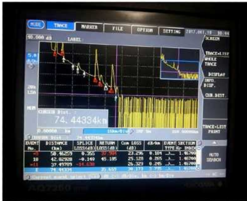
Gambar 4.9 Hasil perhitungan OTDR site Taman Sudiang
