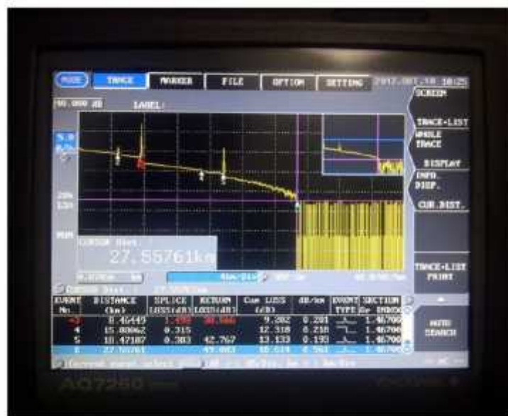
Gambar 4.3 Hasil perhitungan OTDR site Karunrung
