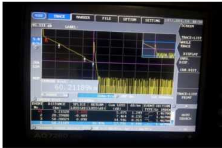
Gambar 4.6 Hasil perhitungan OTDR site Sungai Saddang
