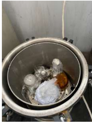
Dilakukan Sterilisasi menggunakan autoclave 121°C pada tekanan 1 atm selama 15 menit
