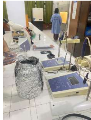
Serbuk daun kemangi dimasukkan kedalam wadah maserasi yang ditutupi aluminium foil lalu dilarutkan ethanol 96% sebanyak 1000 ml dan diaduk 30 menit.
