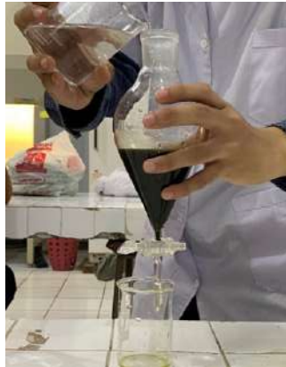
penuangan ekstrak etanol kental pada corong pemisah
