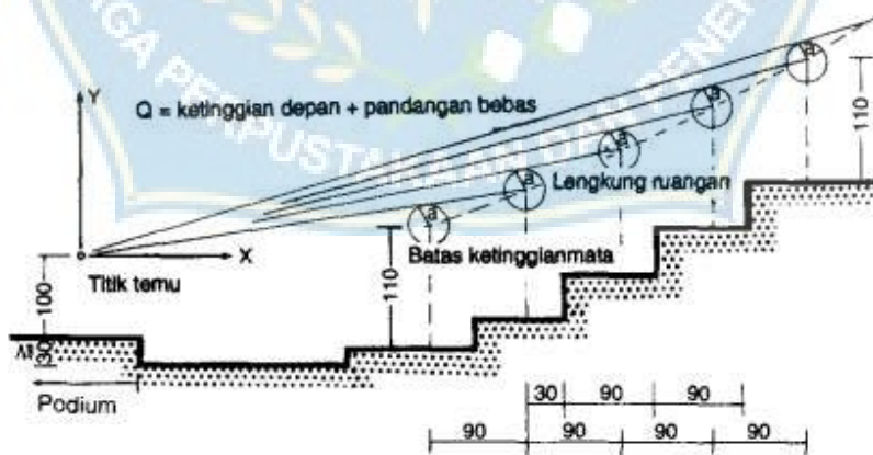
Gambar 2.5 Skema Pandangan Bebas Auditorium (Sumber: Data Arsitek Jilid I)
