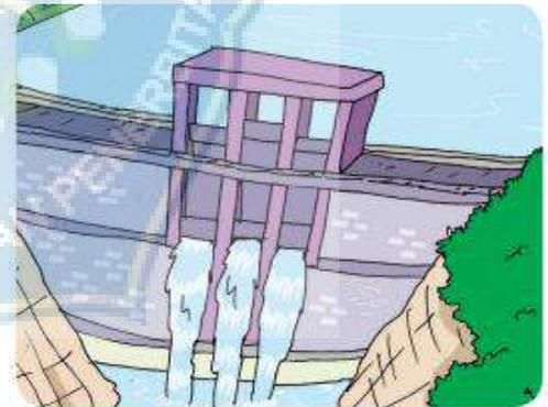
Aliran air dari bendungan atau waduk digunakan untuk menggerakkan turbin yang akan membangkitkan energi listrik. Air merupakan salah satu sumber energi yang cukup berlimpah. Air menyimpan energi yang cukup besar. Aliran air mampu menggerakkan kincir yang dibangun di dekat sungai. Kincir-kincir ini akan dihubungkan dengan generator untuk menghasilkan listrik. Makin deras aliran air, semakin kencang kincir berputar. Energi listrik yang dihasilkan pun semakin besar.
