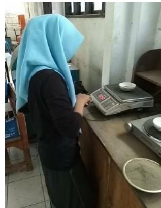
Sampel sedimen ditimbang sebanyak 50 gram untuk pengujian berat jenis
