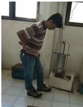
Sampel diayak menggunakan saringan dan mesin sieve shaker selama 15 menit
