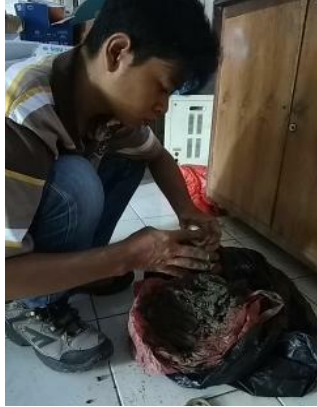
Mengisi tim box yang telah ditimbang kosong dengan sampel sedimen
