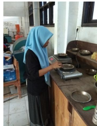
Sampel yang telah di oven ditimbang kembali untuk didapatkan datanya
