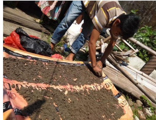
Proses penjemuran untuk mengeringkan sampel sedimen dasarsebelum di uji dilaboratorium
