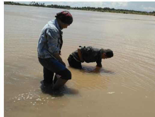
Proses pengambilan sampel sedimen dasar di sungai Saddang Desa Salipolo
