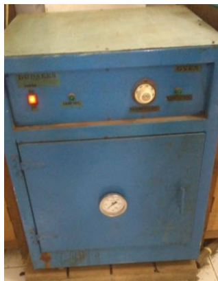
Sampel sedimen dioven selama 24 jam
