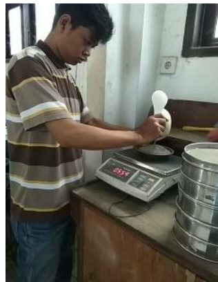
Untuk analisa saringan sampel sedimen yang telah dikeringkan ditimbang sebanyak 1500 gram
