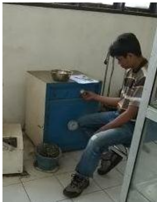
Sampel di oven selama 24 jam kemudian di timbang kembali untuk mengetahui kadar airnya
