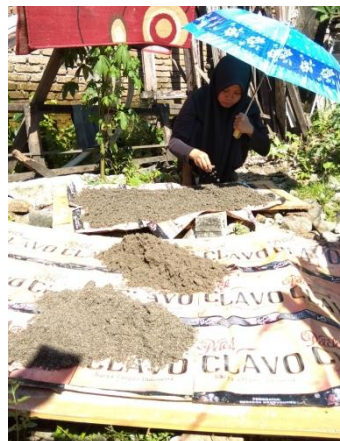
Proses penjemuran untuk mengeringkan sampel sedimen dasarsebelum di uji dilaboratorium
