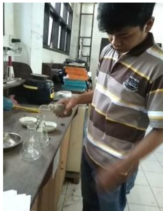
Labu ukur dibersihkan dan dikeringkan sebelum digunakan
