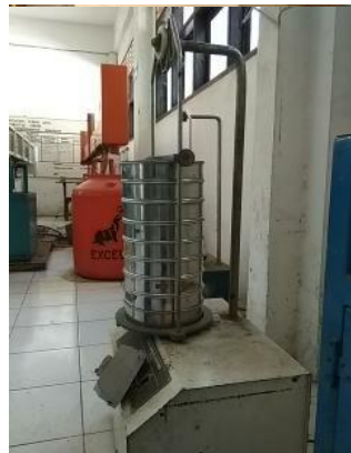
Mesin didiamkan selama 3 menit sebelum menimbang kembali saringan dengan sampel sedimen tertahan
