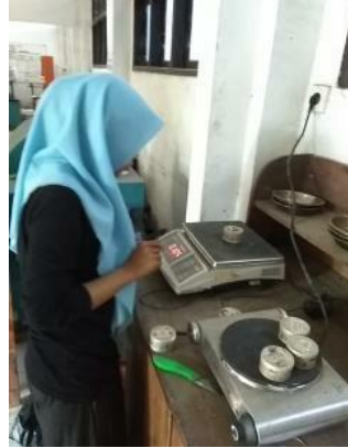
Menimbang tim box yang telah diisi dengan sampel sedimen
