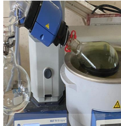
Gambar 8 Proses Penguapan Ekstrak Menggunakan Rotary Evaporator
