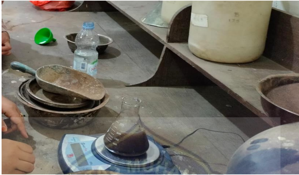
Proses penimbangan labu ukur dan sampel tanah
