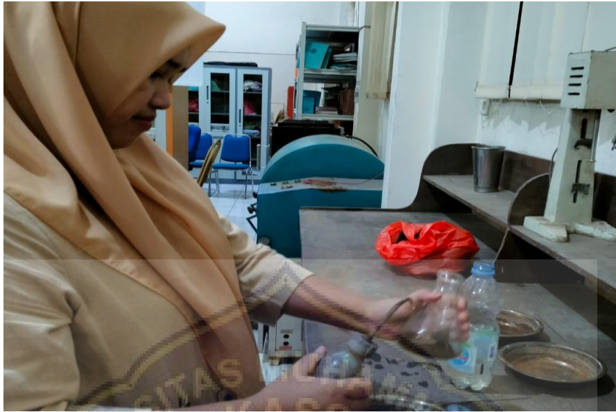
Proses mengeluarkan sampel tanah dari labu ukur
