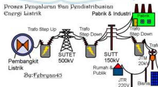
Gambar 2.1 sistem pembangkitan dan penyaluran energi listrik.
