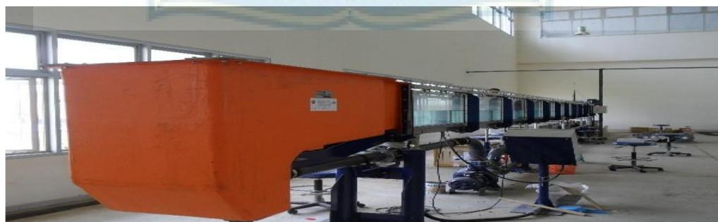
**Gambar 11.** Saluran pembangkit gelombang (*wafe tilting flume*)
