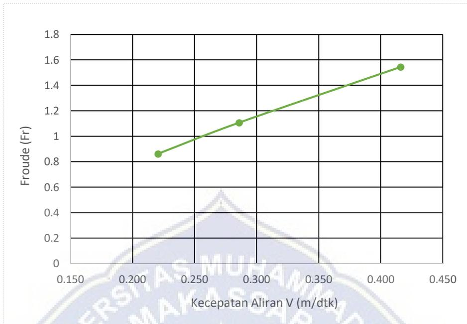
Gambar 4.8. Grafik hubungan kecepatan aliran ( $v$ ) dan angka Froude ( $Fr$ ) Ambang Tertutup (Setelah ambang).
