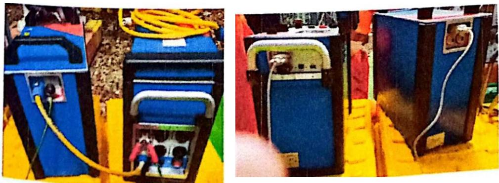
Gambar 4. 8 Rangkaian Alat Ukur CPC 100 dan CP-TD
