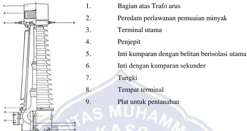
Gambar 2.9 Komponen Trafo Arus Tipe Tangki
