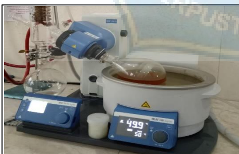
Gambar 17. Rotary evaporator Kulit buah Naga Merah
