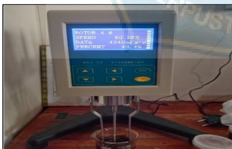
Gambar 35. Uji viskositas F3 7,5% : 3,75%
