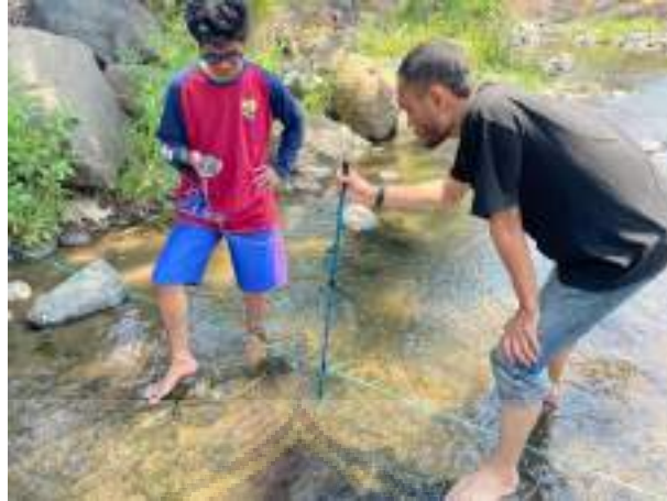
Gambar 1. Pengambilan Data Kecepatan Aliran Sungai Dengan Current Meter
