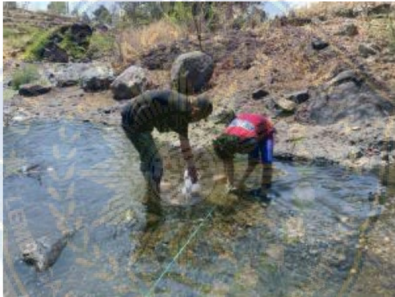
Gambar 7. Pengambilan Sampel Sedimen Dasar
