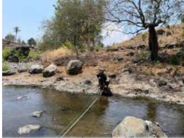
Gambar 4. Pengukuran Lebar Sungai
