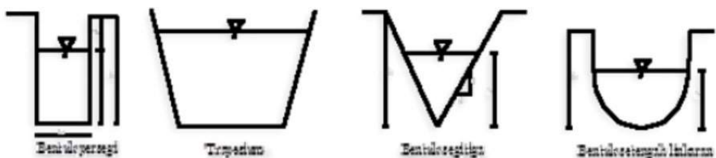
Gambar 2. Bentuk-bentuk potongan melintang saluran terbuka. (Erizal, M, 2013)
