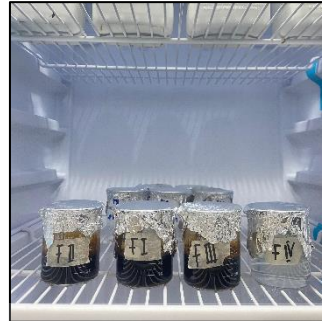
Gambar 14.1. Uji Stabilitas dengan Metode Cycling Test pada Lemari Pendingin dengan suhu 4°C
