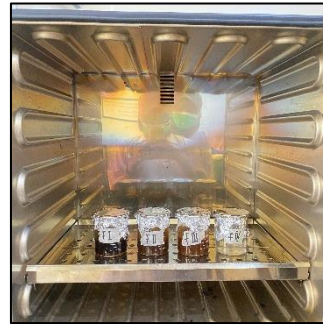
Gambar 14.3. Uji Stabilitas dengan Metode Cycling Test pada Oven dengan suhu 40°C
