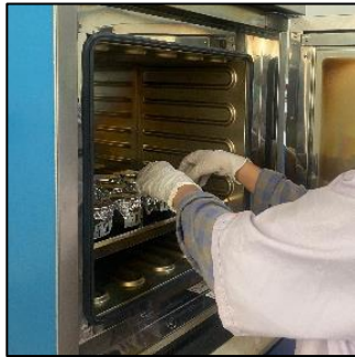
Gambar 14.3. Uji Stabilitas dengan Metode Cycling Test pada Oven dengan suhu 40°C
