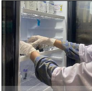
Gambar 14.1. Uji Stabilitas dengan Metode Cycling Test pada Lemari Pendingin dengan suhu 4°C
