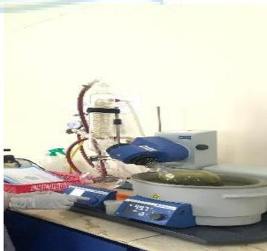
**Gambar 3.6.** Proses penguapan dengan rotary evaporator
