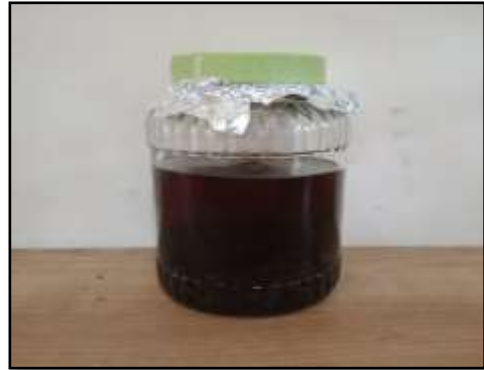
Gambar 4.8. Proses maserasi sampel selama 3 x 24 jam
