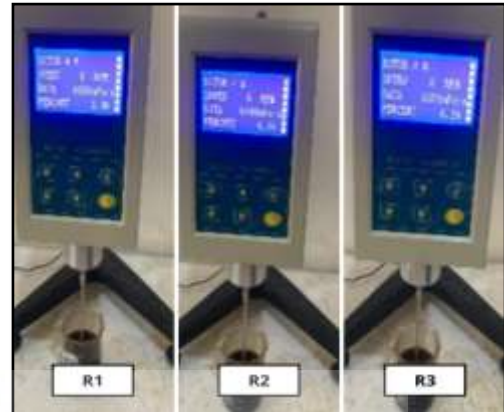
Gambar 7.20. Uji viskositas formula 1 setelah Cycling test
