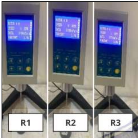
Gambar 10.7. Uji viskositas formula 2 hari ke- 14
