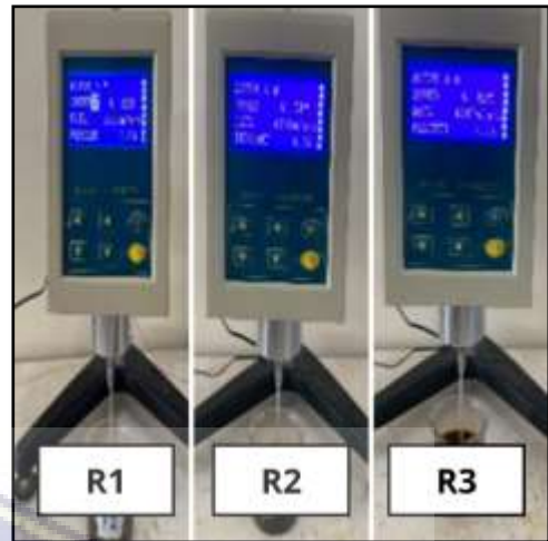
Gambar 8.8. Uji viskositas formula 3 hari ke-0
