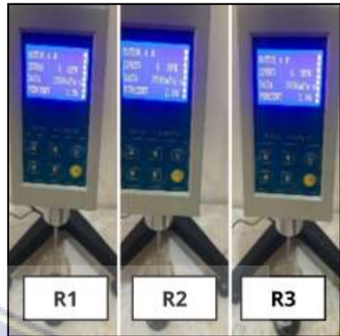
Gambar 10.8. Uji viskositas formula 3 hari ke- 14
