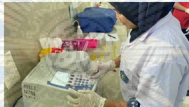
Gambar 14. 2 Pengujian Sampel dengan Instrumen Spektrofotometri Uv-Vis
