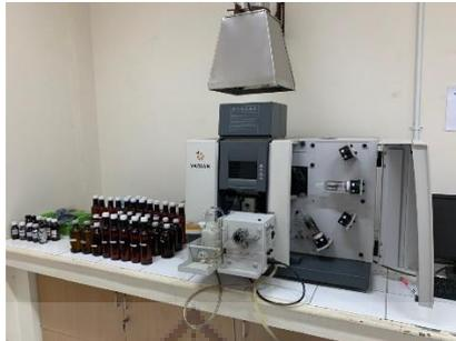
**Gambar 17.1.** Serangkaian Alat Spektrofotometri Serapan Atom (SSA)
