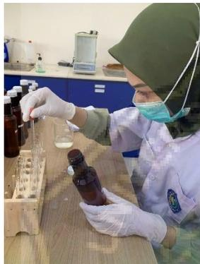
**Gambar 15.2.** Diambil masing-masing 1 ml larutan uji kemudian masukkan dalam tabung reaksi
