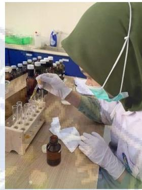
**Gambar 16.3.** Ditambahkan  $K_2CrO_4$  10 % Sebanyak 5 tetes kedalam masing-masing tabung reaksi
