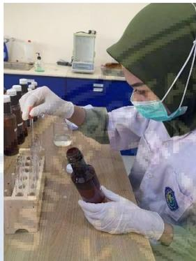
**Gambar 16.2.** Diambil masing-masing 1 ml larutan uji kemudian masukkan dalam tabung reaksi
