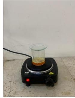
**Gambar 12.4.** Didestruksi di atas *Hotplate* Selama 3 jam hingga terbentuk larutan jernih
