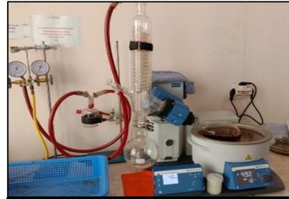
**Gambar 8.** Diuapkan menggunakan *rotary evaporator*
