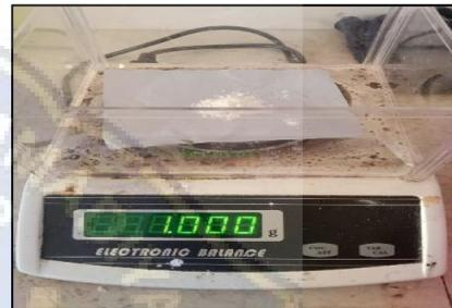
**Gambar 22.** Penimbangan bahan (etil cellulosa)
