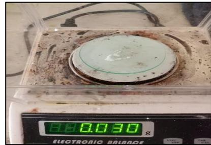
**Gambar 20.** Penimbangan bahan (metilparaben)
