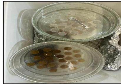
**Gambar 65.** Dimasukkan kedalam wadah tertutup berisi silica gel selama 24 jam
