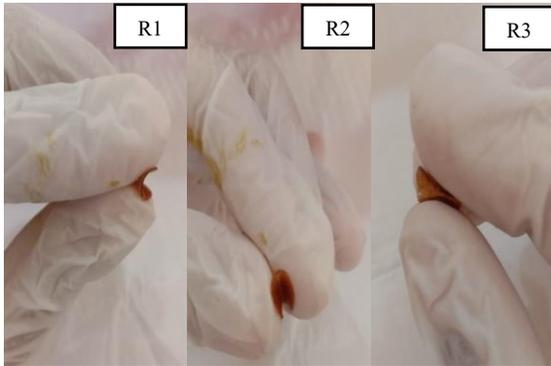
**Gambar 88.** Uji ketahanan lipat F2 setelah *cycling*
