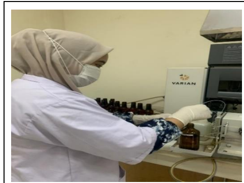
Gambar 20. Pengujian kuantitatif pada Spektrofotometri Serapan Atom (SSA)
