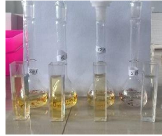
Gambar 17. 3. Larutan standar dibuat dalam konsentrasi 5ppm, 10ppm, 15ppm, dan 20ppm
