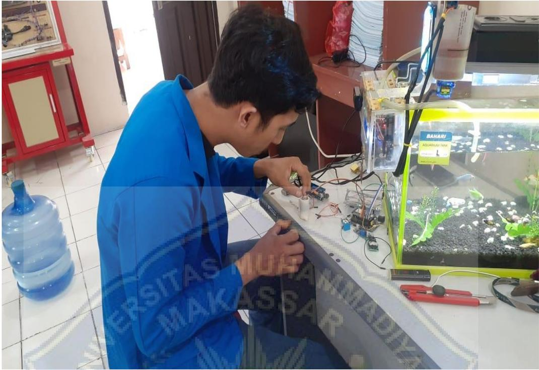
Gambar 5.3 Perakitan pompa air 5 volt
